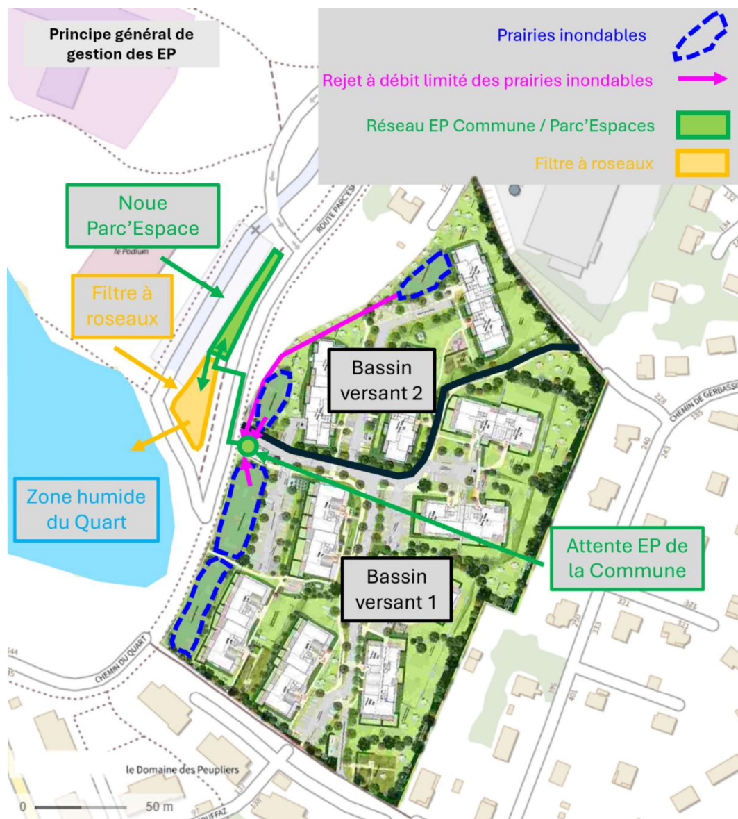
Figure 14 : Principe de gestion des eaux pluviales (MPC, 2024)
