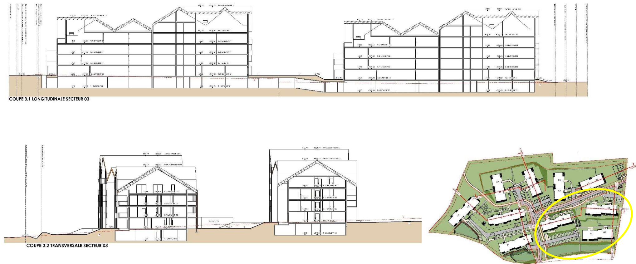
Figure 8 : Coupe longitudinale et coupe transversale au niveau des bâtiments du secteur 3
