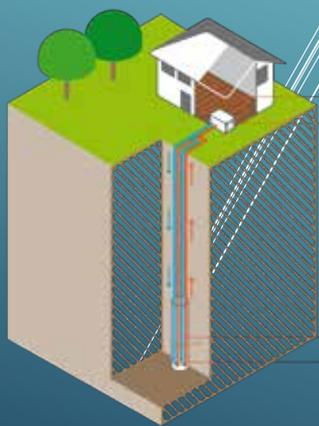
Le principe est simple : on installe des systèmes pour capter la chaleur du sol. Une pompe à chaleur géothermique utilise cette énergie pour chauffer en hiver et rafraîchir en été. Plus en profondeur, la vapeur d'eau chaude peut produire de l'électricité via des turbines.
